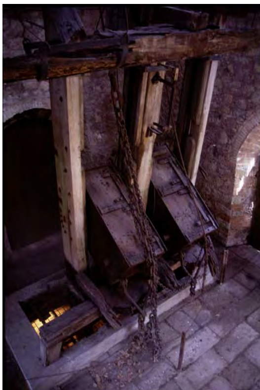
Le cabine dell'elevatore all'interno del pozzo Alfredo (001b)
