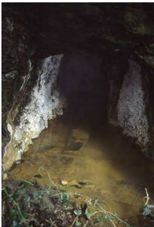
Modesta galleria di ricerca subito allagata da una sorgente di acqua sulfurea
