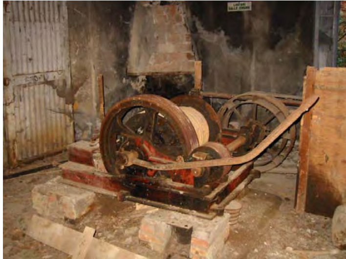
Argano posto alla sommità del piano inclinato della discenderia Ciampolini (BPB)
